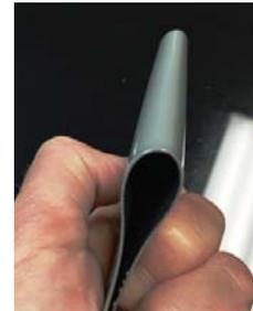
*Mesmo com sua notável dureza contra riscos e batidas (4H), NCF continua flexível. Esse painel de aço ferro-fosfatado pintado com Macropoxy 646 e posteriormente revestido com NCF, dobra-se ao meio sem craquelar ou qualquer outra falha no revestimento.*
